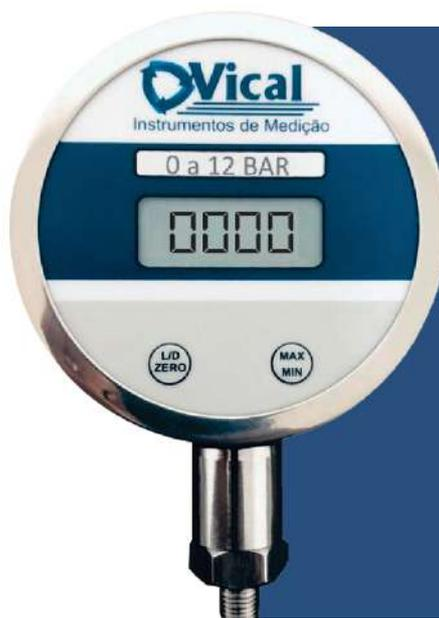
O Manômetro Vicpress 1001 é um instrumento c/ alta precisão de medição sendo indicado tanto para uso como padrão em laboratórios como para monitoração em campo. Desenvolvido com a mais moderna técnica de condicionamento de sinais e utilizando sensores piezo-resistivos, o instrumento permite a amostragem de grandezas de pressão com alta resolução em um display de cristal líquido de 4½ dígitos.
